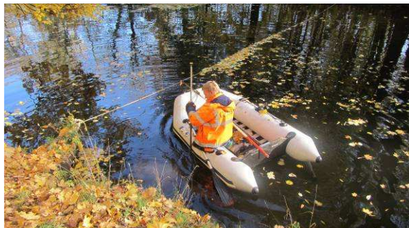
Abbildung 4: Schlammmächtigkeitsbestimmung, Wehr Brühl Quedlinburg
